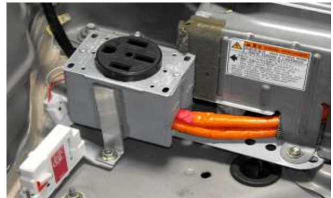
Figura 7: Conector para acoplamiento de batería adicional
