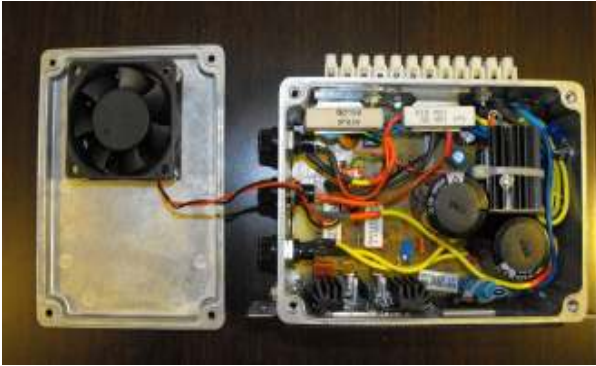
Figura 8: Cargador conmutado utilizado en el proyecto
